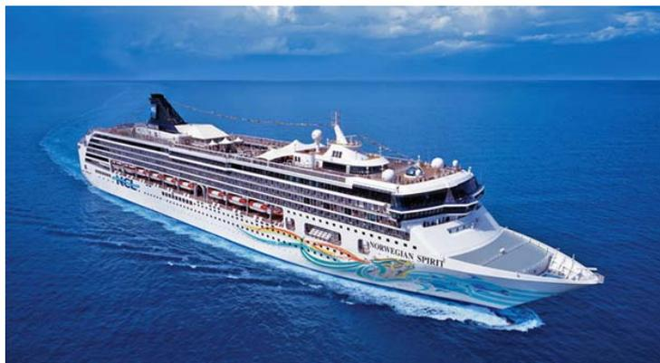
该轮长 880 英尺，高 13 层，总吨位 7.7 万，航速 24 节，客户容量 1966，船员 800。乘客可隔玻璃窗看驾驶室内各种设施，全是电子化仪表操作，卫星导航。另闢老式驾驶舵室，供人玩味照相。
